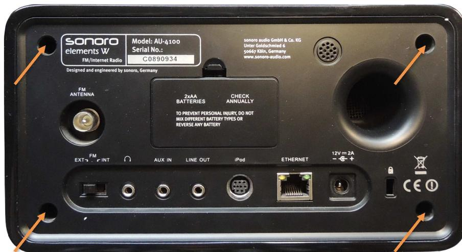
Nach Entfernen der 4 Schrauben lässt sich die Rückwand mit dort befestigten Elektronikkomponenten aus der Gehäuseschale herausziehen.
