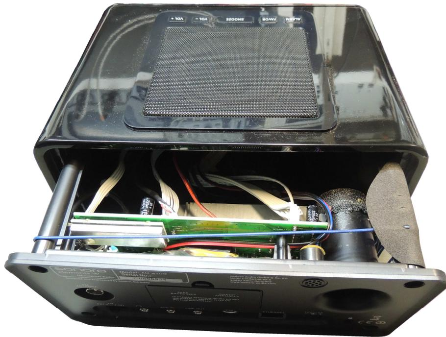
Die Rückwand vorsichtig ziehen und die einzelnen Kabel beobachten, damit dort keine Beschädigungen durch Zug entstehen oder Steckverbindungen getrennt werden, die man später nicht sicher zuordnen kann.
